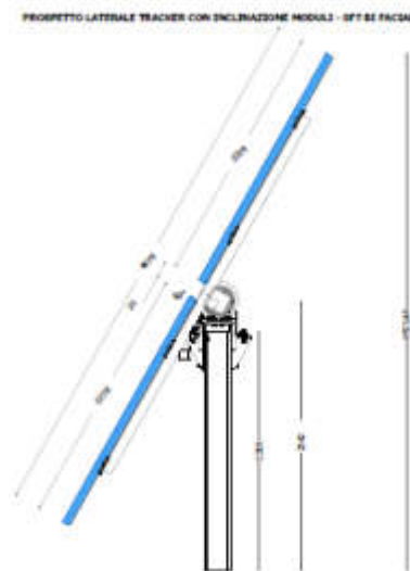
Figura 14: Inclinazione pannelli 55/60^\circ sull'orizzontale
