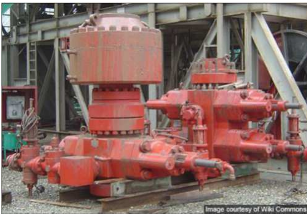
Figura 4.1.4 – BOP STACK 13 5/8" composto da BOP Anulare, Ram preventer Singolo e Ram preventer Doppio
