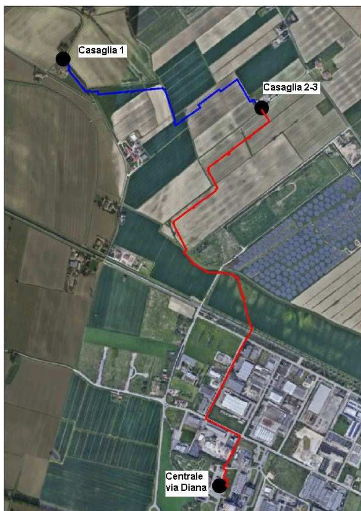
Figura 2.2.1 – Ubicazione impianti e tracciato delle tubazioni in progetto (in blu la tubazione per la re-iniezione del fluido geotermico, in rosso le tubazioni dell'acqua della rete di teleriscaldamento)
