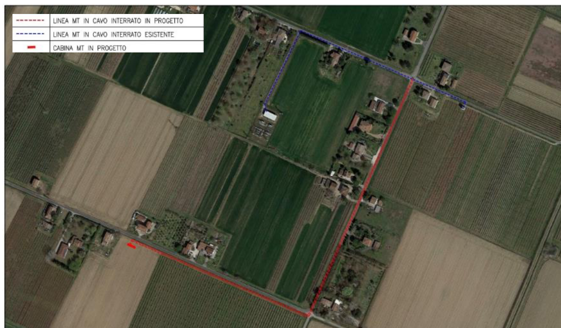
Figura 11 – Estratto planimetria di progetto dell'impianto di connessione: linee MT e cabine MT
