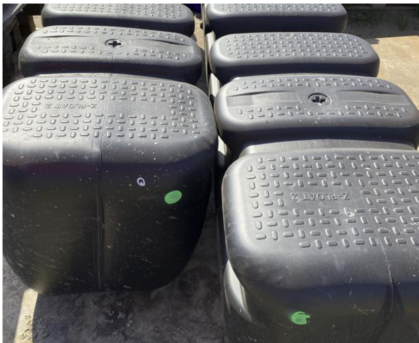
Foto 3 – moduli galleggianti in HDPE montati al di sotto delle zattere dell'impianto.
