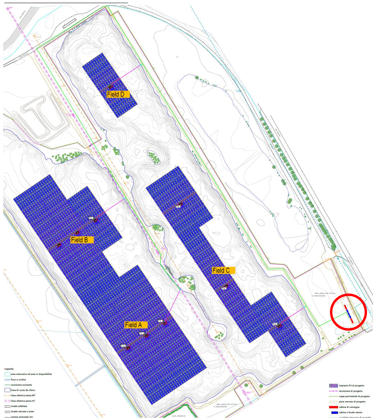
Fig. 16 – layout progettuale. Il cerchio rosso sulla destra in figura indica la zona nella quale saranno posizionate le cabine di consegna punto da quale parte la linea di connessione con cavo interrato alla CP Cervia.
