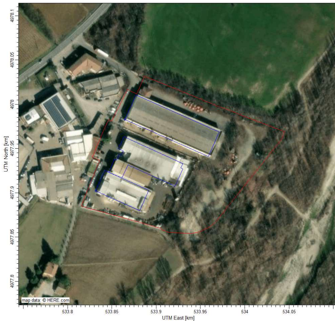
Figura 5 - Edifici inseriti (contorno blu) per l'attivazione del building downwash
