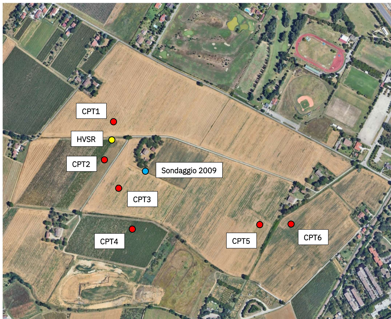
Figura 7: Ubicazione prove effettuate: in rosso prove CPT, in giallo HVSR e in azzurro sondaggio da banca dati
