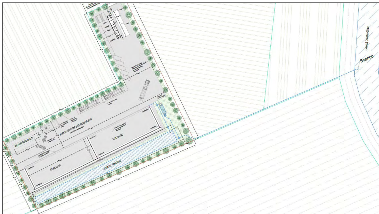
Figura 85 - Stralcio Planimetria generale (SPA 01.01) con dettaglio sistema gestione acque
