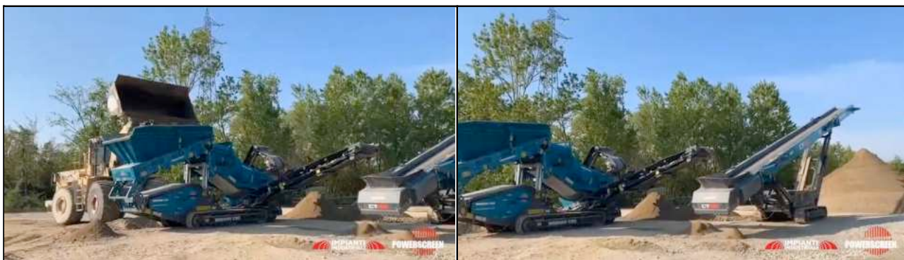
Fig. 3.1 - Immagini che illustrano l'accoppiamento di un vaglio Powerscreen 1200 Warrior con il nastro di rilancio CT65 per la messa in opera di un cumulo di materiale cernito. A sinistra la fase di carico della tramoggia con pala gommata, a destra il trasferimento del materiale trattato per la formazione del cumulo di stoccaggio.
