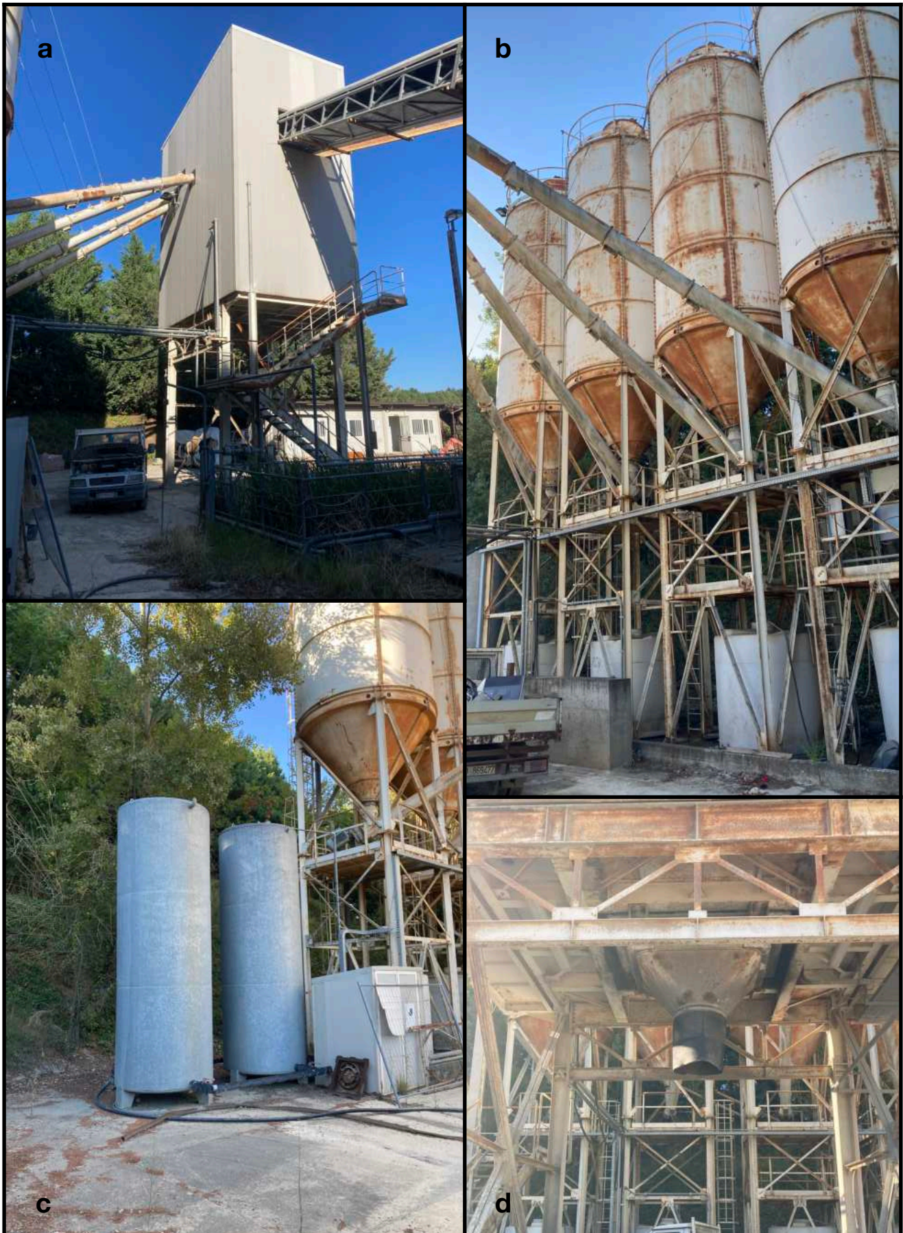
Figura 7 - Componenti dell'impianto di betonaggio di via Palazzina 3: a) alloggiamento del mescolatore e dei dosatori, nastro trasportatore degli inerti (a destra) e le quattro coclee per il trasporto del cemento (a sinistra); b) sili del cemento, relative coclee e serbatoi degli additivi (alla base dei sili); c) serbatoi per l'acqua di impasto; d) dettaglio della manica di carico della betoniera ubicata alla base del mescolatore.
