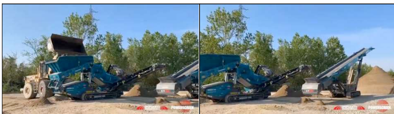
Fig. 2.8 - Immagini che illustrano l'accoppiamento di un vaglio Powerscreen 1200 Warrior con il nastro di rilancio CT-65 per la messa in opera di un cumulo di materiale cernito. A sinistra la fase di carico della tramoggia con pala gommata, a destra il trasferimento del materiale trattato per la formazione del cumulo di stoccaggio.
