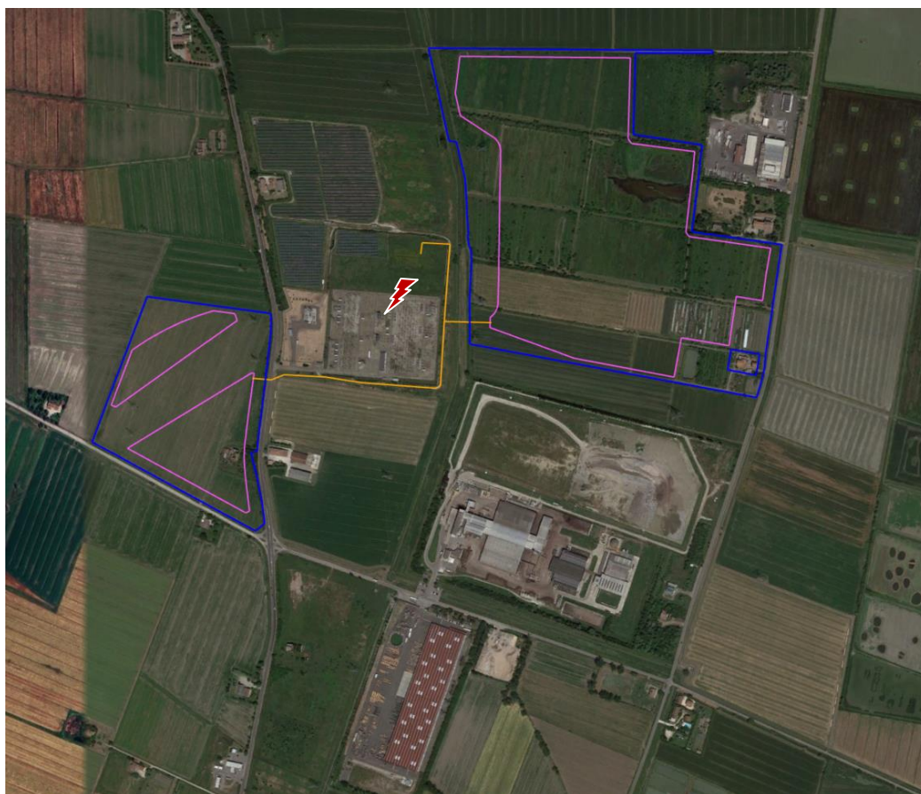
Figura 3. Localizzazione puntuale dell'area di intervento e relative opere di rete su foto satellitare: linea blu = superficie catastale; linea magenta = area di impianto; linea arancione = cavidotto di connessione; puntalino rosso = Stazione elettrica 380/132/36 kV "Carpi Fossoli" – (Fonte cartografica di base: Google Earth).
