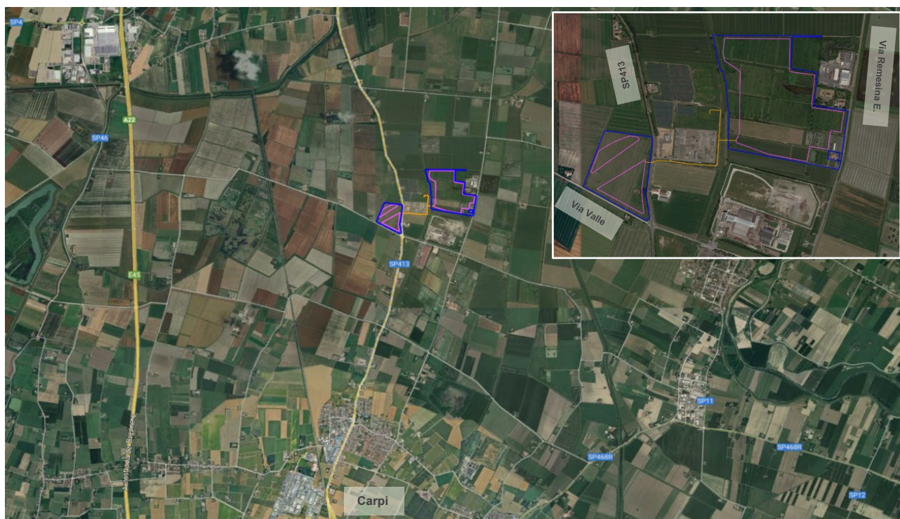
Figura 3. Localizzazione dell'area di intervento su foto satellitare rispetto alla rete stradale esistente. Linea blu = superficie catastale; linea magenta = area di impianto; linea arancione = cavidotto di connessione (Fonte cartografica di base: Google Earth).
