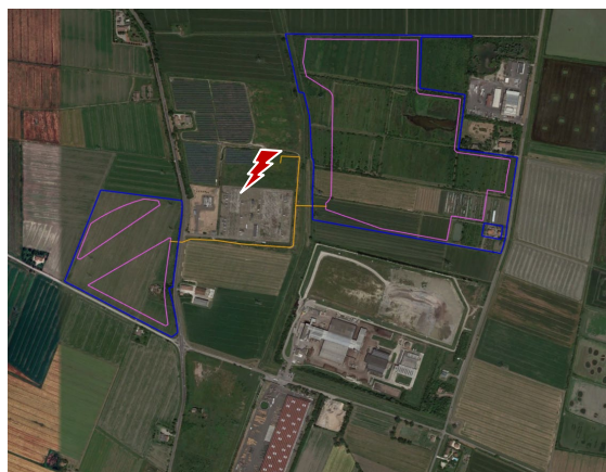
Figura 2. Localizzazione puntuale dell'area di intervento e relative opere di rete su foto satellitare: linea blu = superficie catastale; linea magenta = area di impianto; linea arancione = cavidotto di connessione; puntalino rosso = Stazione elettrica 380/132/36 kV "Carpi Fossoli" – (Fonte cartografica di base: Google Earth).
