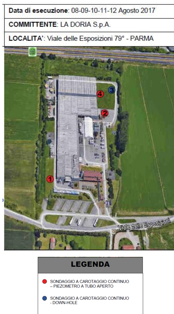
Fig. 63 - Punti oggetto di sondaggio a carotaggio continuo.
