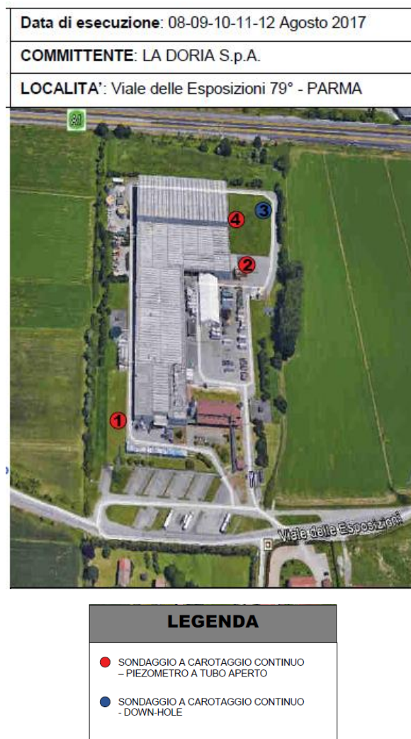
Fig. 64 - Punti oggetto di sondaggio a carotaggio continuo.
