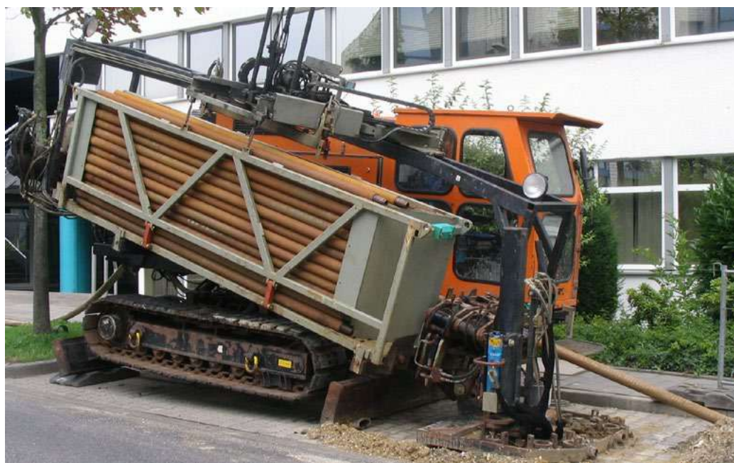
Figura 5-7 – Esempio tipo di perforatore orizzontale
