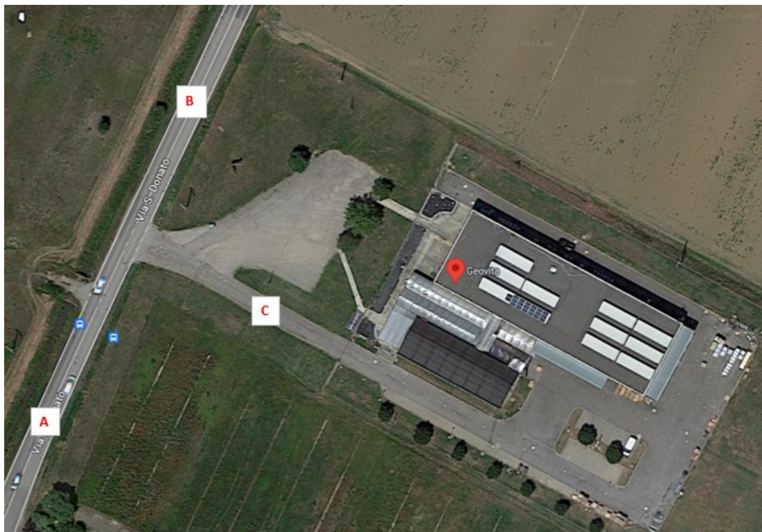
Figura 13. Identificazione dei rami dell'intersezione per il calcolo del LOS (caso A)
