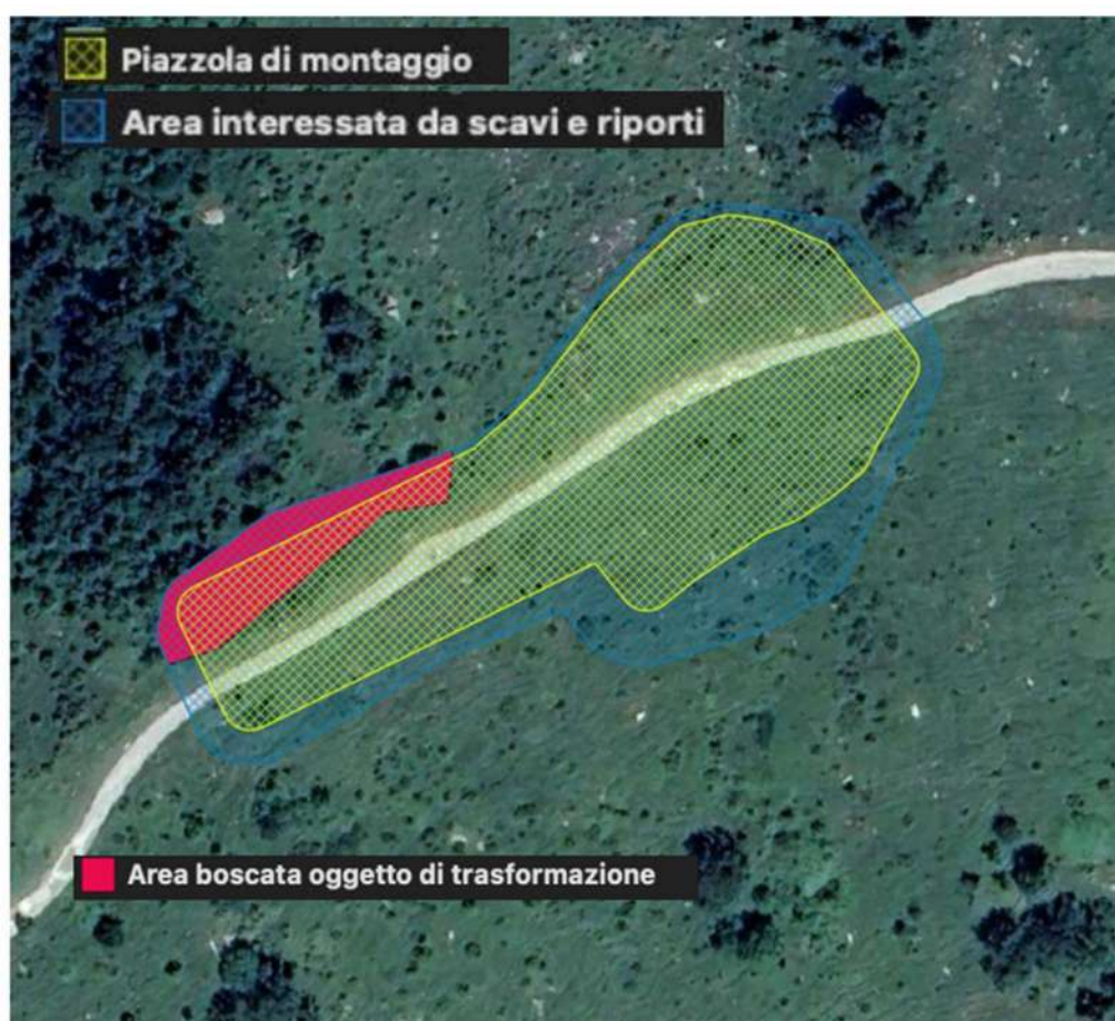
Figura 27 - WTG e Cabina di consegna Planimetria aree boscate trasformate
