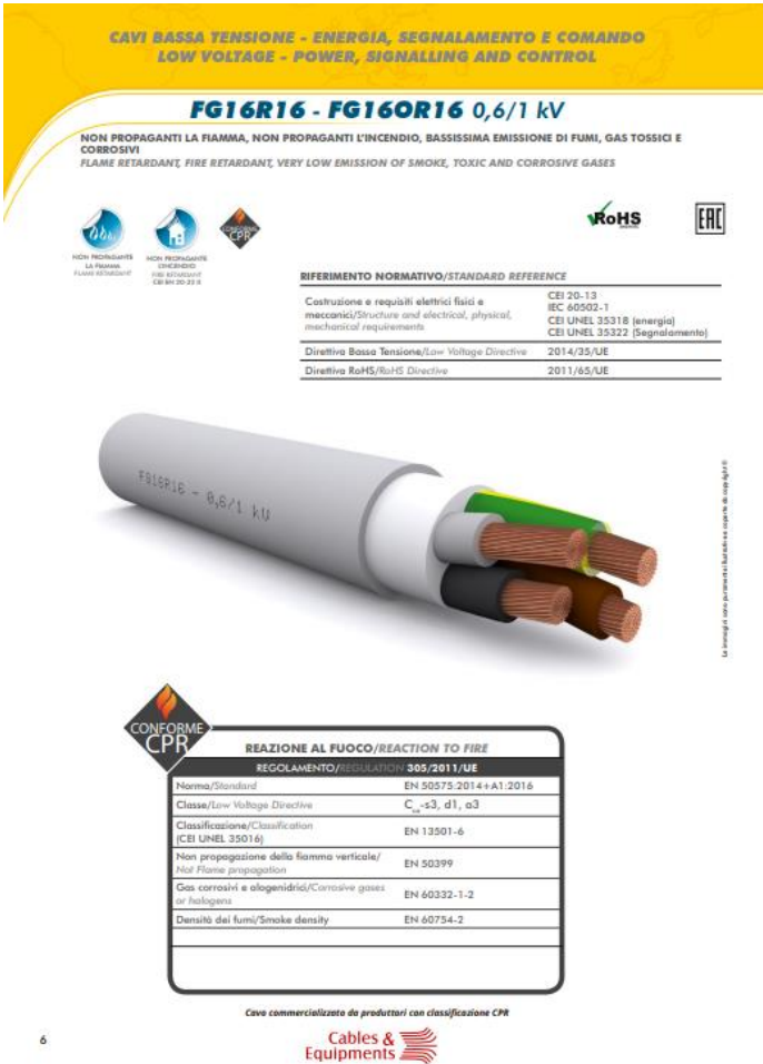
Figura 6: Scheda tecnica del cavo scelto per le connessioni inverter – quadro di parallelo
