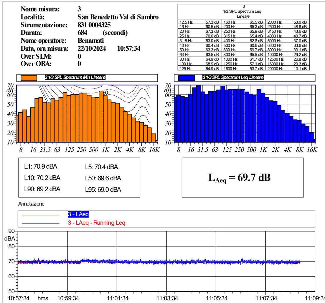
Il rilievo sopra riportato è stato eseguito lungo il confine Sud Ovest, di front al gruppo frigo e all'emissione E2. Durante il rilievo il rumore era principalmente generato da tali sorgenti. Il livello equivalente dell'intero rilievo è pari a 69,7 dBA. Il microfono era posizionato lungo il confine di proprietà, a circa 7 m dall'emissione E2 e ad una altezza di 4 m. Non sono presenti componenti tonali.
