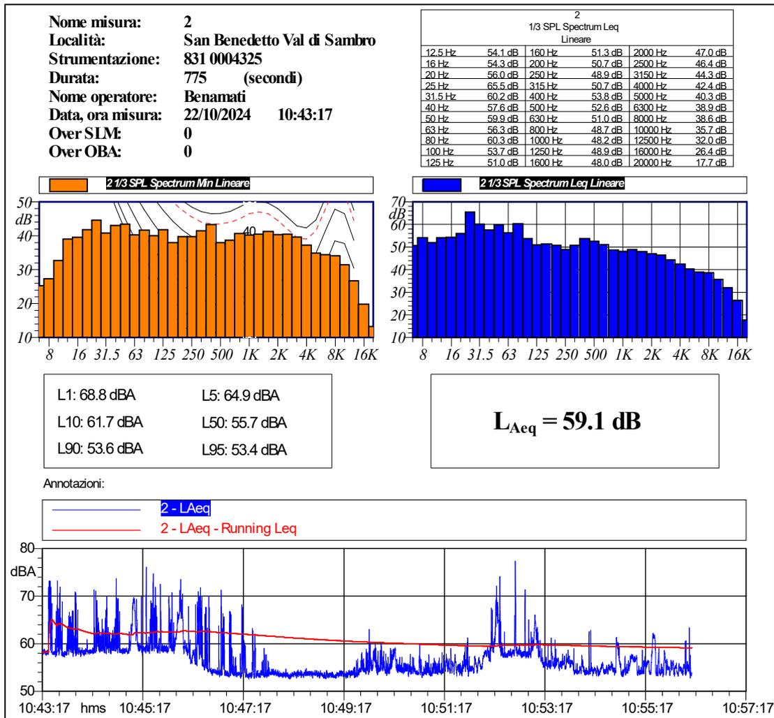
Il rilievo sopra riportato è stato eseguito lungo il confine Nord Ovest, di fronte alle baie di carico.
