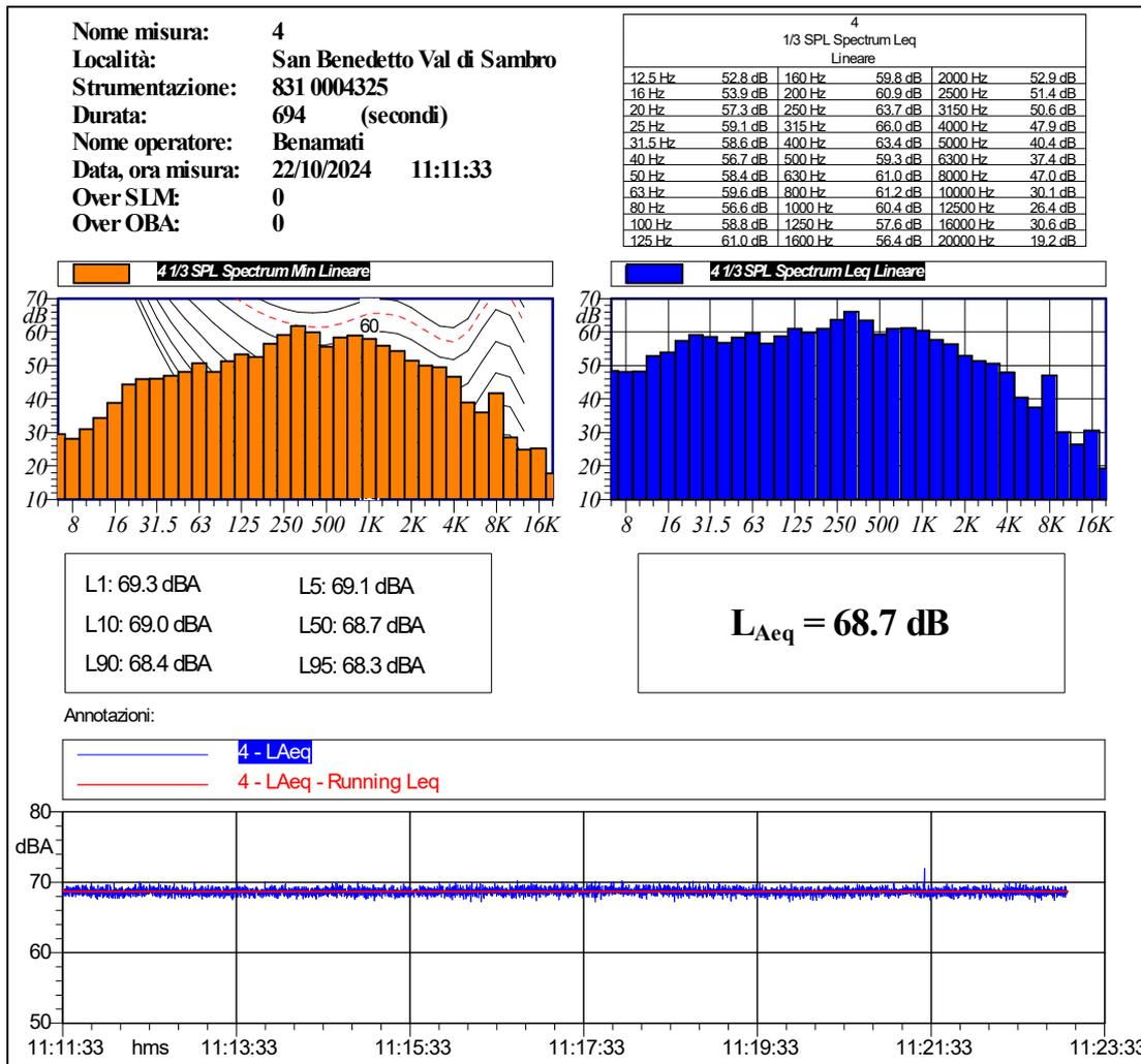
Il rilievo sopra riportato è stato eseguito a circa 6 m di distanza dall'emissione E15. Il rumore era generato principalmente generato dal tale impianto. Il livello equivalente dell'intero rilievo è pari a 68,7 dBA.
