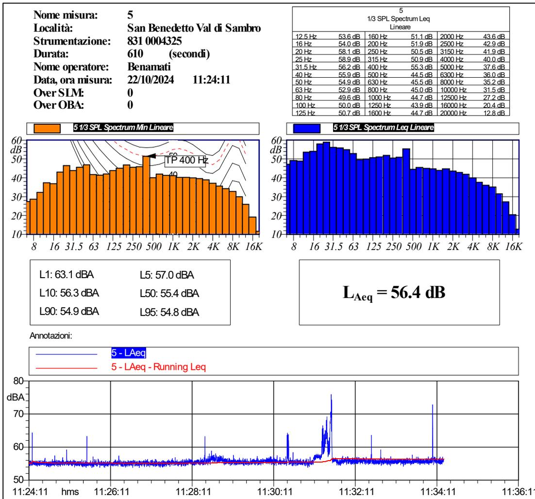
Il rilievo sopra riportato è stato eseguito al confine Sud Est di stabilimento. Durante il rilievo era percepibile il rumore generato dalle sorgenti fisse di stabilimento e dalla movimentazione nel piazzale.
