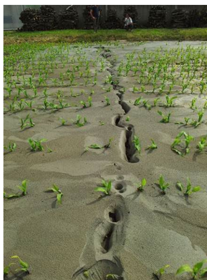
Figura 6-14– Foto fenomeno di liquefazione nell'area dell'alto ferrarese a seguito dei terremoti del 20 e 29 Maggio 2012
