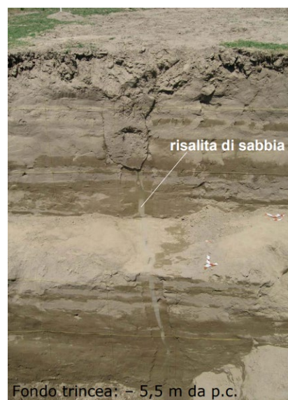
Figura 6-14– Foto fenomeno di liquefazione nell'area dell'alto ferrarese a seguito dei terremoti del 20 e 29 Maggio 2012
