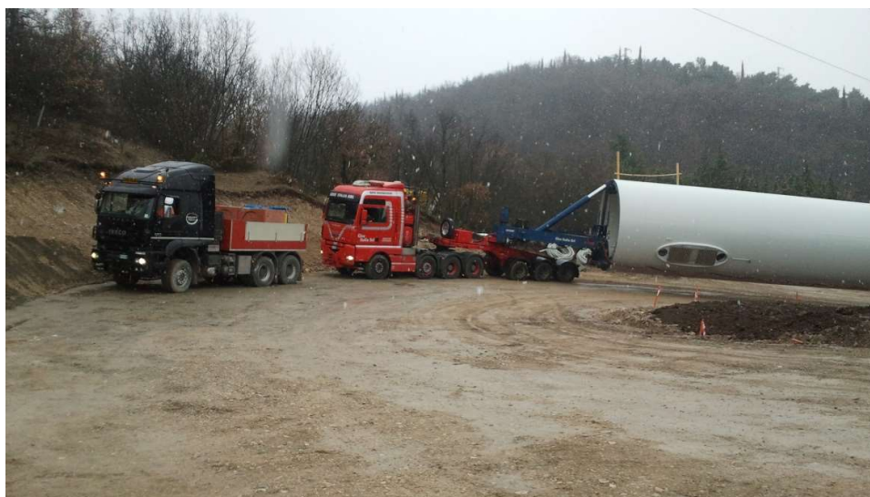
Esempio di traino durante il cantiere dell'impianto eolico Monte Mesa di AGSM
