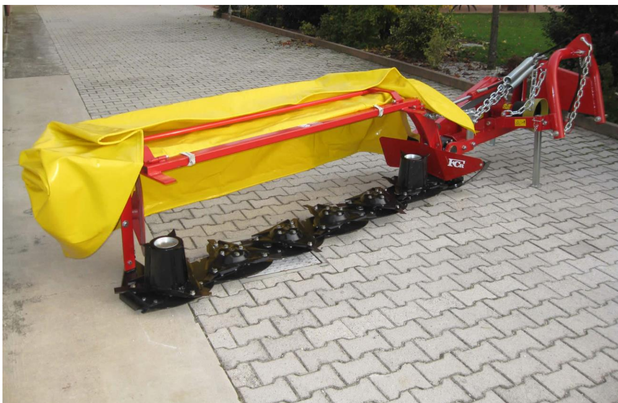
Figura 50. Falciatrice rotativa a dischi con larghezza di lavoro di circa 2,50 metri
