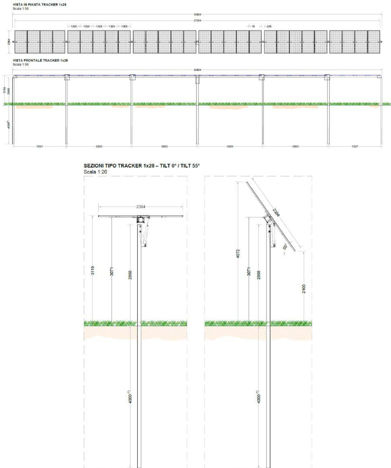
Figura 38 – Pianta e prospetti struttura Tracker configurazione 1x28.
