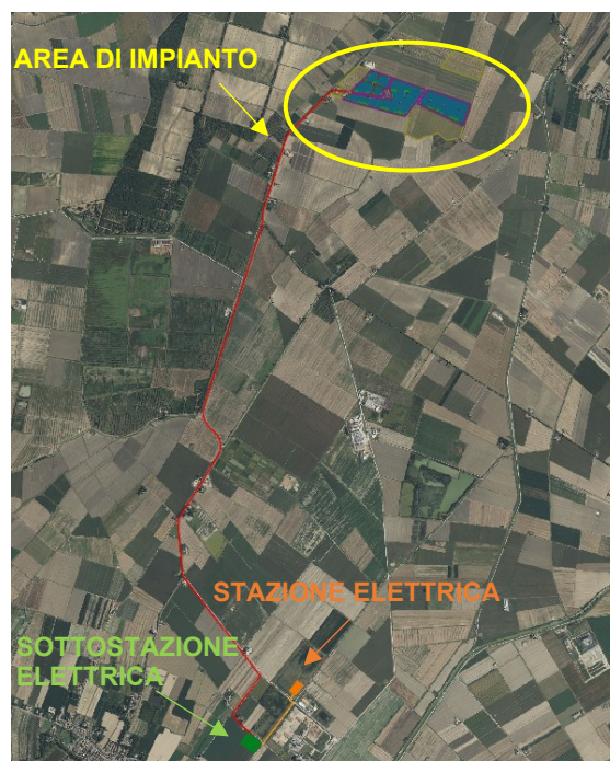
Figura 1 - Inquadramento su ortofoto del cavidotto MT
