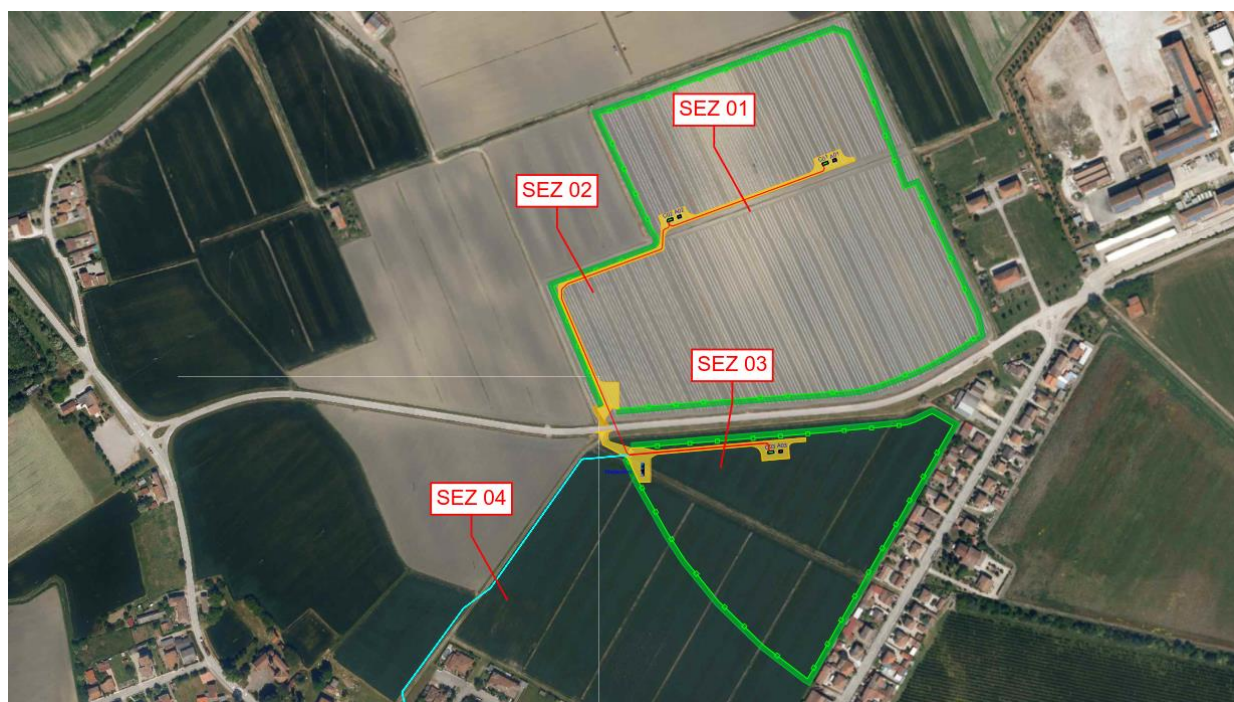
Figura 5-1 – Sezioni per definizione campo magnetico, cavi 36 kV – Aree 1 e 2
