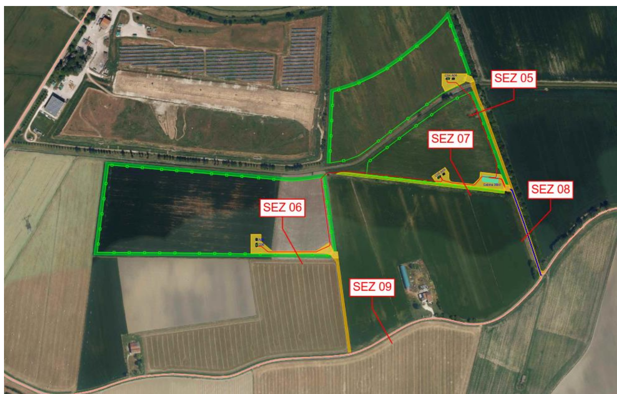
Figura 5-2 – Sezioni per definizione campo magnetico, cavi 36 kV – Area 3, 4 e 5
