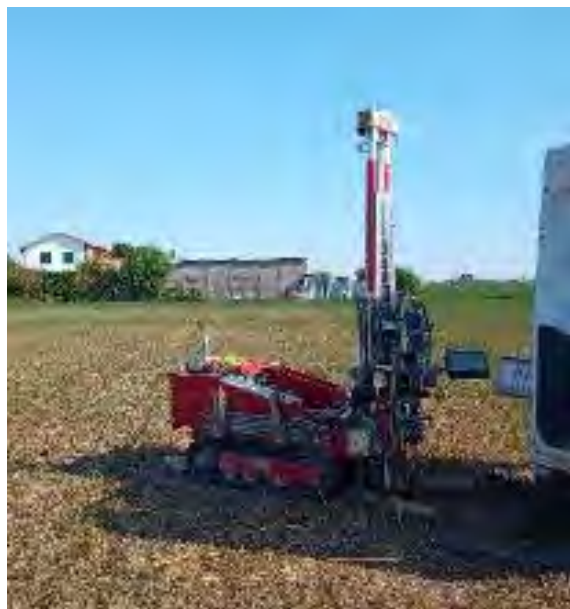
Fig. 7.2 – Penetrometro TG63-200
