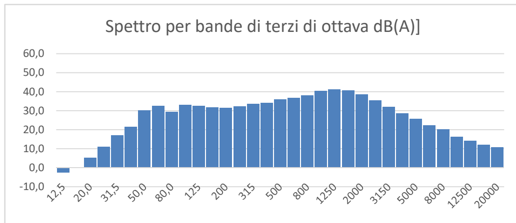
Figura 7-7 – Postazione PM1 - Spettro dei livelli acustici per bande di terzi di ottava [dB(A)]
