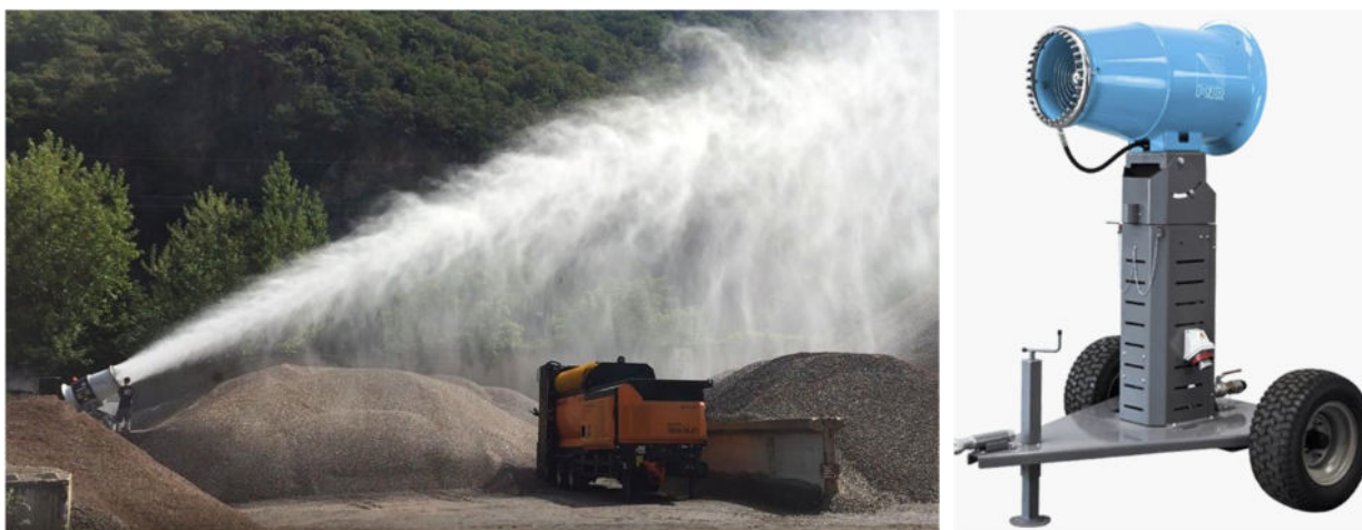
Figura 9-1 – Barrieramento ad acqua mediante fog cannon
