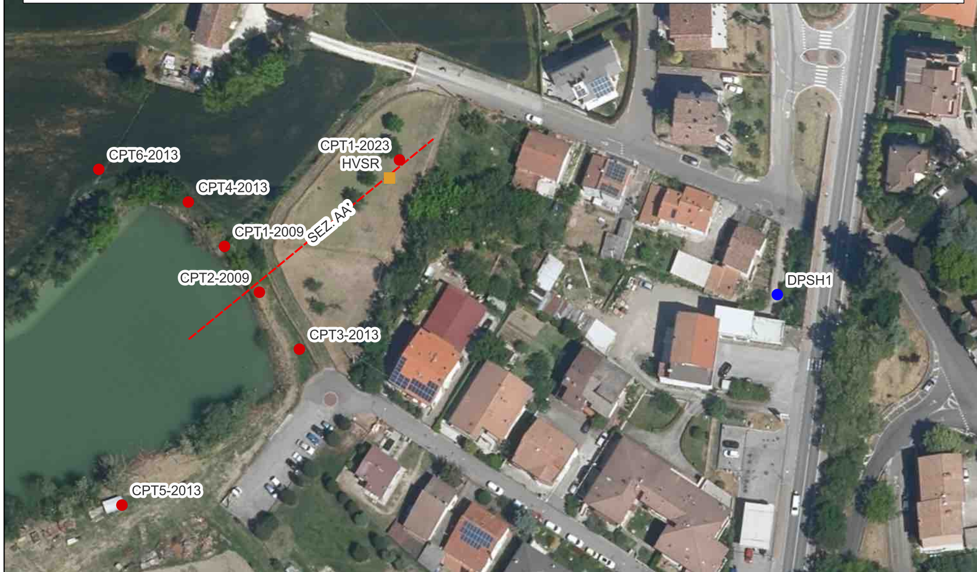
TAVOLA 6: ORTOFOTO EMILIA-ROMAGNA (2020) - SCALA 1:1000 CON INDICAZIONE DEI PUNTI DI ESECUZIONE DELLE INDAGINI GEOGNOSTICHE E GEOFISICHE ESEGUITE E DISPONIBILI E TRACCIA DELLA SEZIONE
