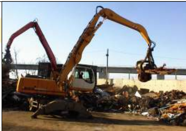
Figura 6.1 – Scheda tecnica dei “ragni” gommati con benne a polipo Liebherr A924 in dotazione alla ditta
