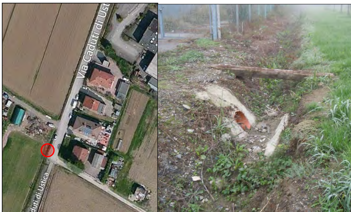
Figura 8 – Immagine e posizione del fosso in cui si immetteranno le acque laminate. Nell'immagine è presente una tubazione che serve per lo scolo delle acque del sottopasso.
