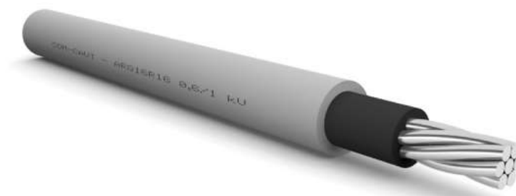
Figura 20: Cavo unipolare in alluminio di tipo ARG16R16 - 0,6/1 kV
