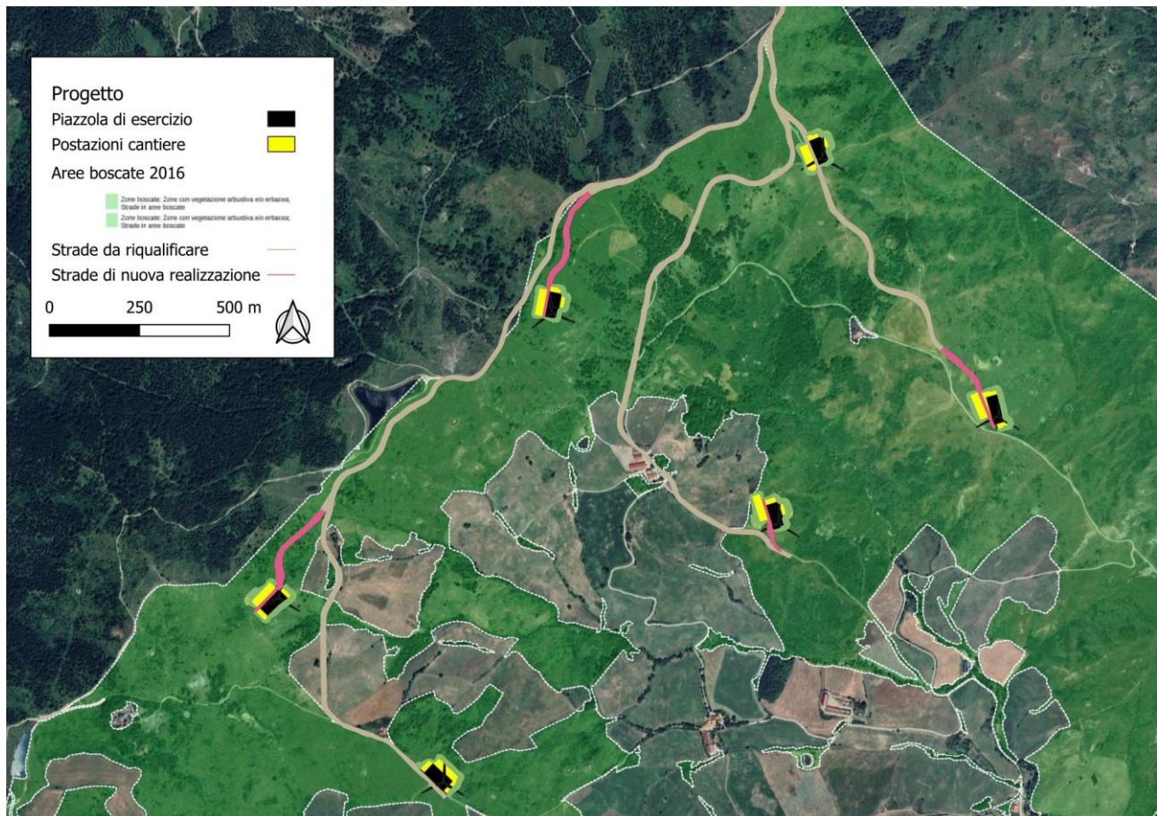
Figura 15. Sovrapposizione delle opere di progetto alla mappa delle aree boschive secondo Regione Toscana – Geoscopio.
