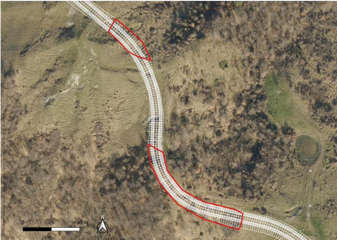
Figura 33. Rappresentazione cartografica delle aree di interferenza con le aree boschive (in rosso) in corrispondenza della viabilità di collegamento tra WTG3 e WTG6
