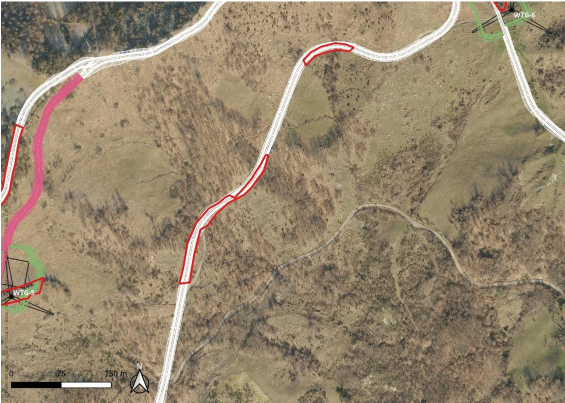
Figura 30. Rappresentazione cartografica delle aree di interferenza con le aree boschive (in rosso) in corrispondenza della viabilità di accesso alla WTG4
