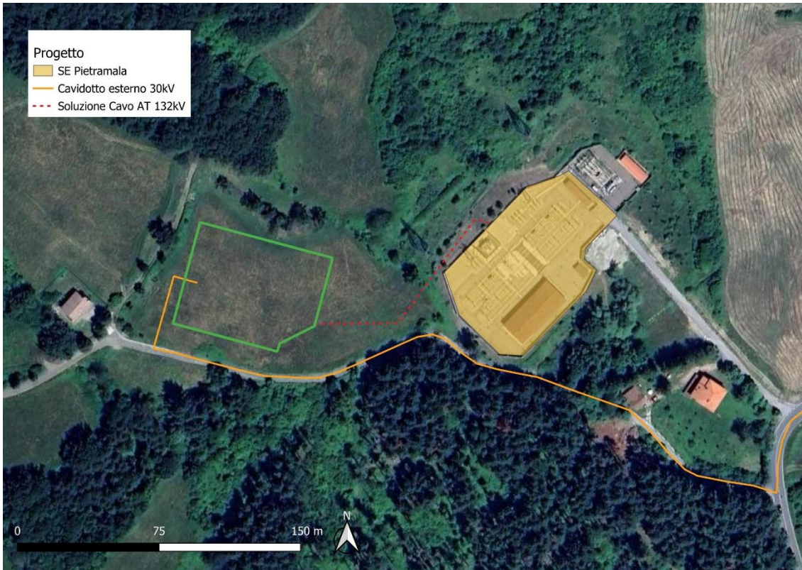
Figura 36. Rappresentazione cartografica delle aree di interferenza con le aree boschive in corrispondenza della SSU condivisa nei pressi della esistente SE Pietramala
