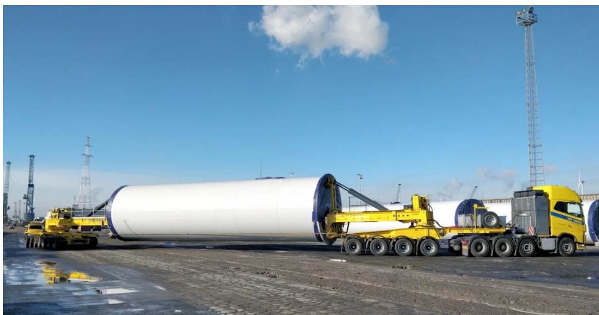
Carrello per conci turbina con adattatore verticale di altezza dal piano stradale
