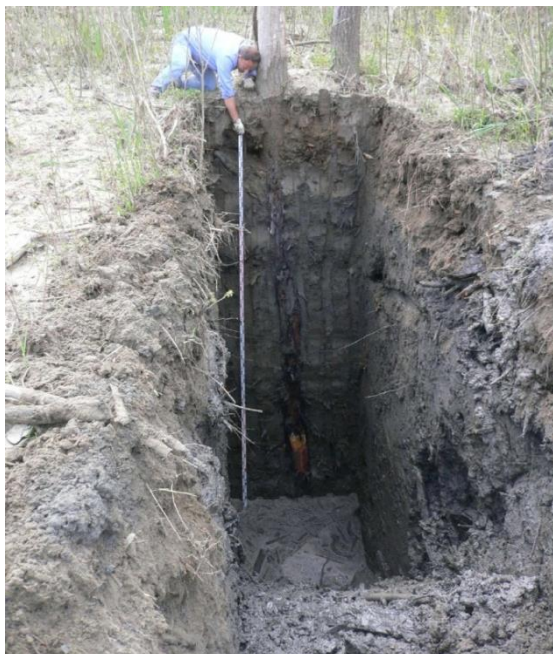
Foto 4 – Scavo esplorativo n. 3 all'interno della cassa in linea
