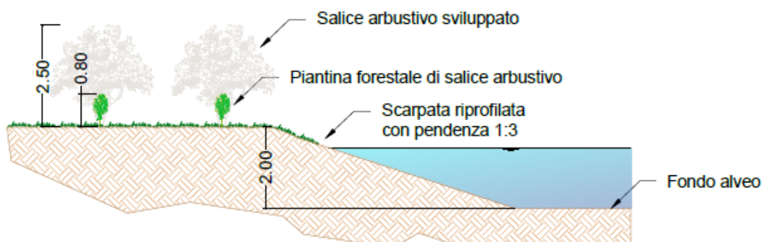
Figura 16: Estratto della sezione tipo delle piantumazioni arbustive previste sulle isole fluviali, sesto d'impianto e modalità di piantumazione.
