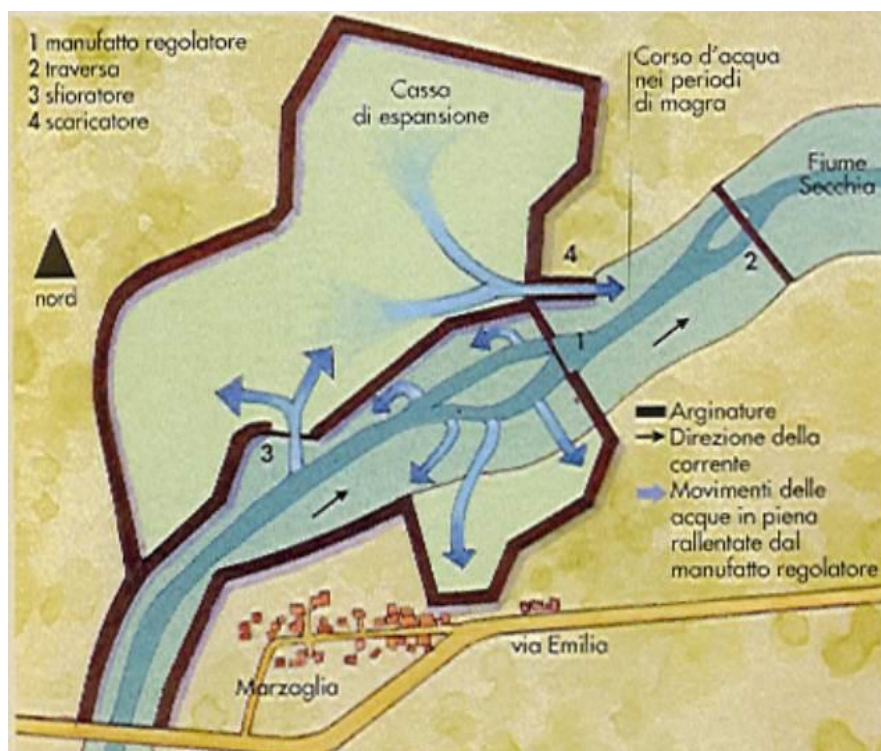
Figura 2: Schema di funzionamento della Cassa del Secchia.
