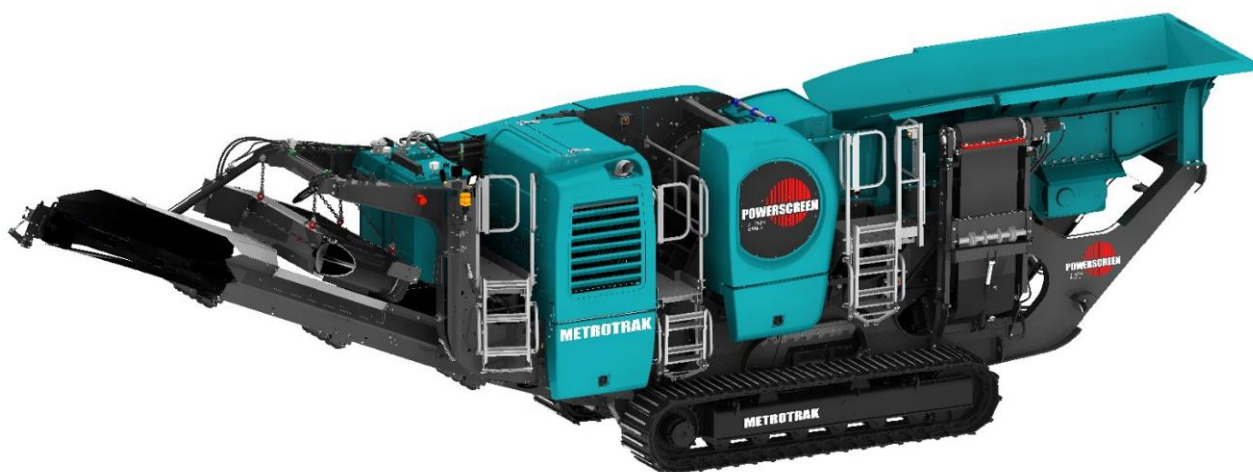
Figura 9 - Frantoio mobile (documentazione completa Allegato 3)
