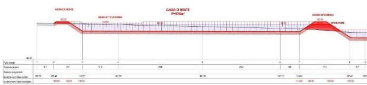
FIGURA 46: RIO ENZOLA, CASSA DI LAMINAZIONE DI MONTE: PROFILO LONGITUDINALE
