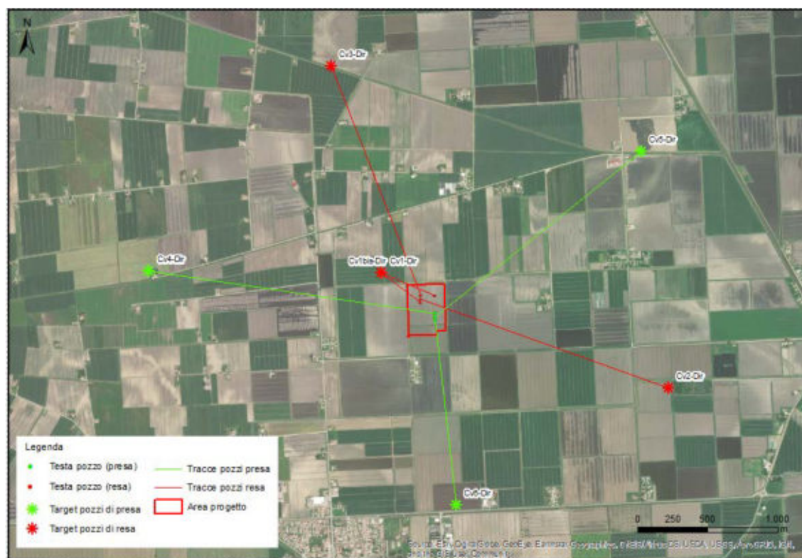
Figura 47. Ubicazione dei pozzi in progetto e proiezione in superficie della deviazione in profondità
