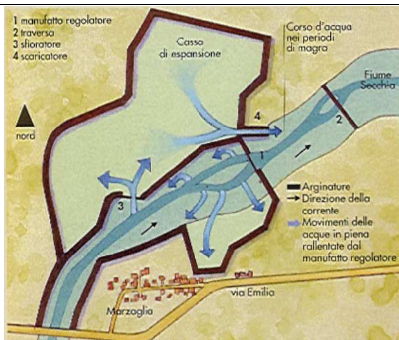
Figura 3 – Schema di funzionamento della Cassa del Secchia
