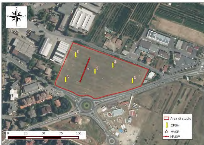
Figura 3.2.3 – Ubicazione delle indagini geognostiche DPSH eseguite nel luglio 2015.
