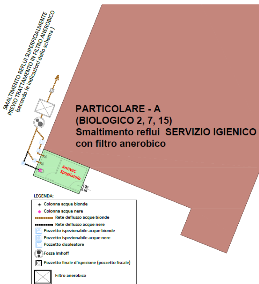
Servizi igienici e schema sistema di depurazione
