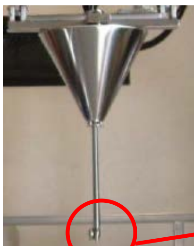
Figura 6 – Testina rotante di spruzzamento
