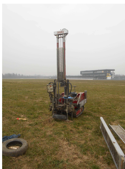
Fig. 2.1.2: Penetrometro utilizzato per eseguire le prove penetrometriche nell'area di interesse
