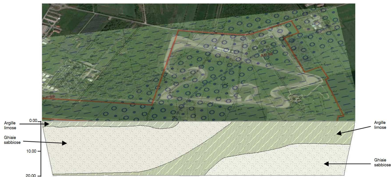
Fig. 4.1.9: Sovrapposizione carta geologica CARG Regione Emilia Romagna e profili stratigrafici delle unità geologiche identificate.
