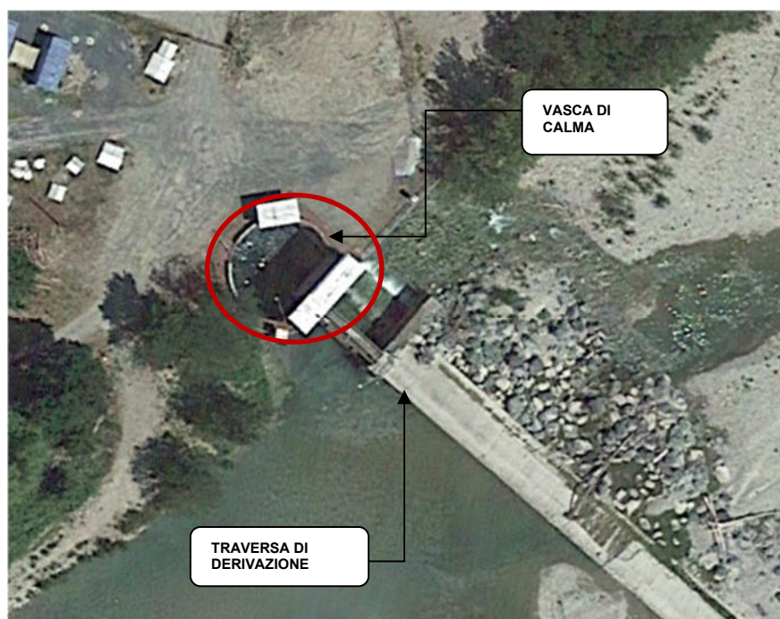
FIGURA 5-2: PARTICOLARE DEL MANUFATTO DI DERIVAZIONE E DELLA VASCA DI CALMA
