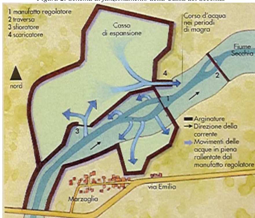
Figura 2: Schema di funzionamento della Cassa del Secchia.
