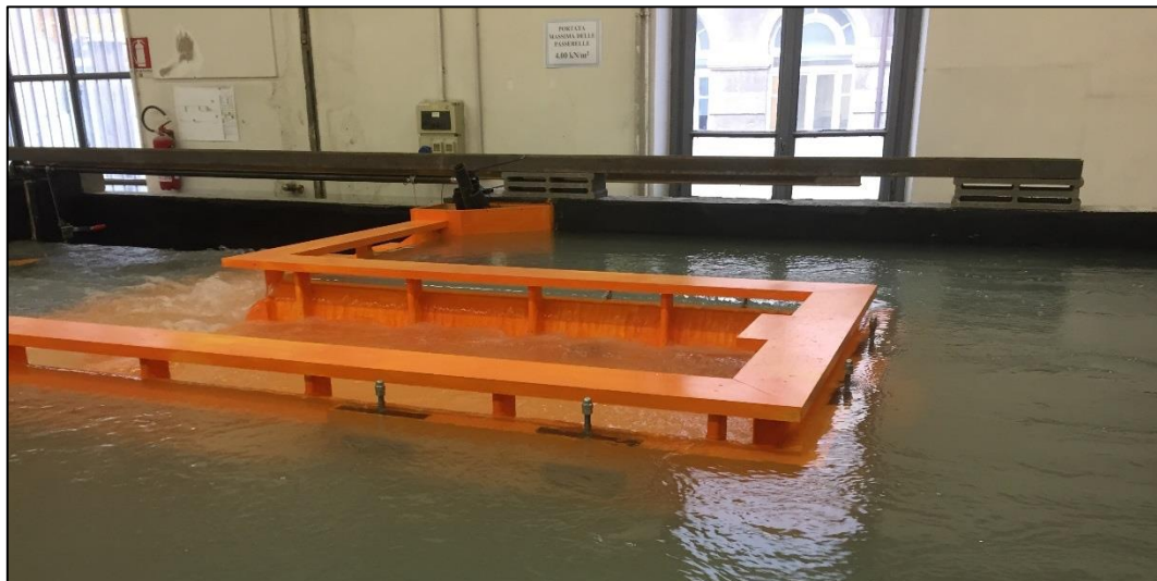
Figura 15 – Funzionamento del modello fisico con paratoie completamente chiuse e funzionamento degli sfioratori di superficie
