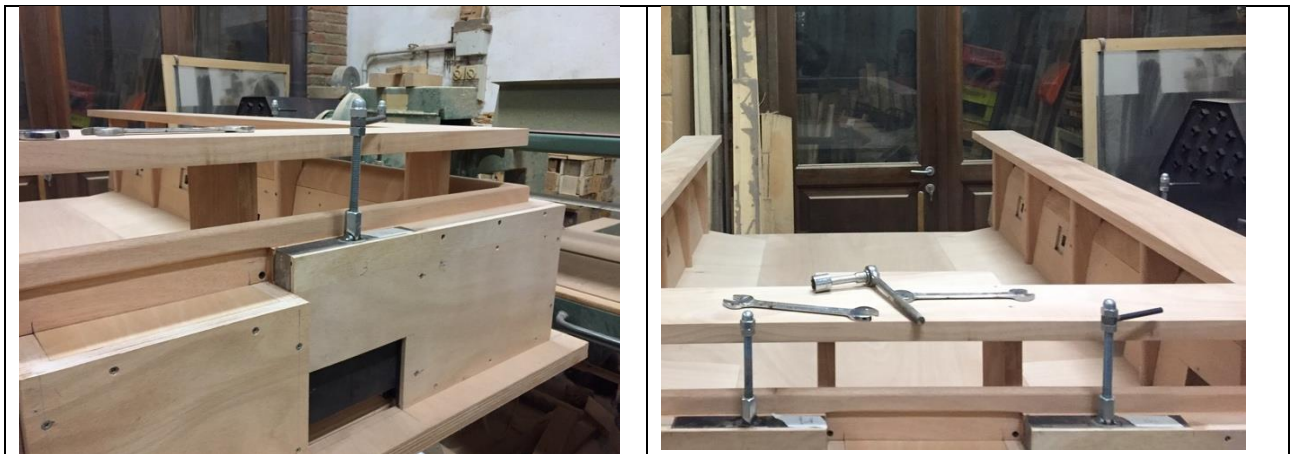
Figura 4 – Fasi di realizzazione della parte in legno e dei particolari delle paratoie e delle superfici di sfioro
