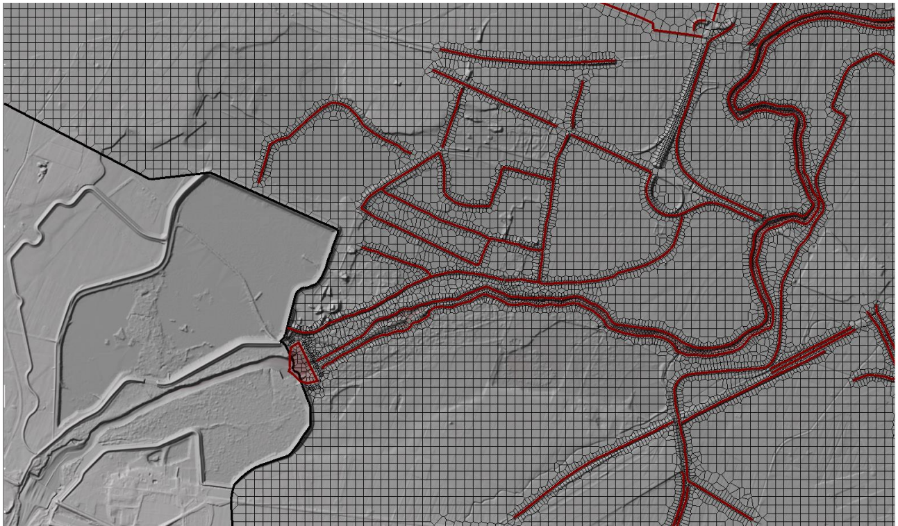
Figura 11. Dettaglio dello schema di discretizzazione del dominio di calcolo con “ mesh ” non strutturata. Le linee in rosso rappresentano le “ break-line ”.
