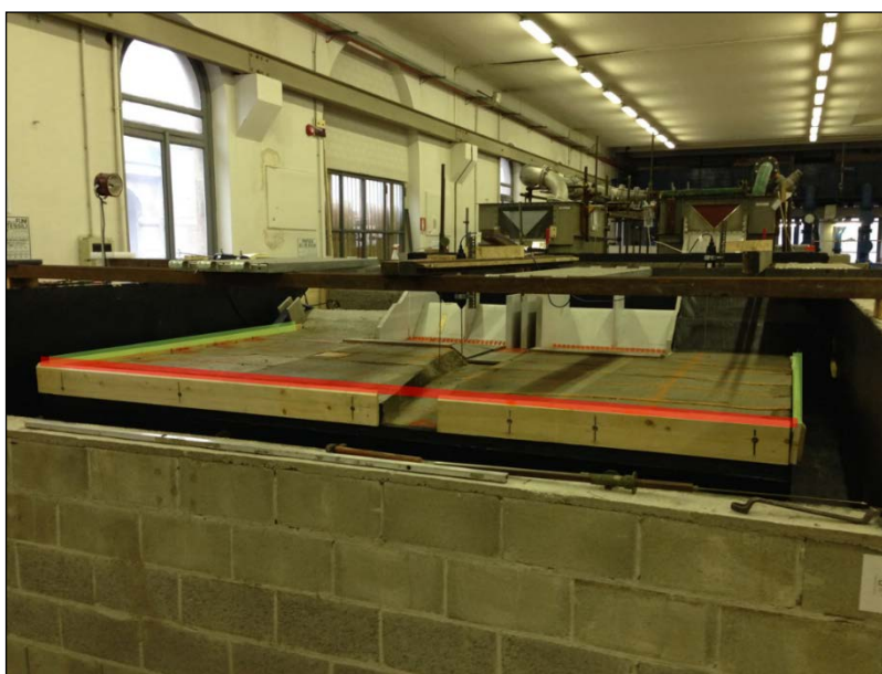
Figura 10 ESEMPIO DI REALIZZAZIONE ANALOGA (MODELLO FISICO RELATIVO ALLE OPERE DI SFIORO DELLA VASCA DI LAMINAZIONE DEL FOSCO DI PRATOLUNGO). LE CONDIZIONI AL CONTORNO DI VALLE SONO STATE RICREATE ATTRAVERSO PARATOIE REGOLABILI ALL'ESTREMITÀ DELLA PIANA (LINEA ARANCIONE E LINEE VERDI)
