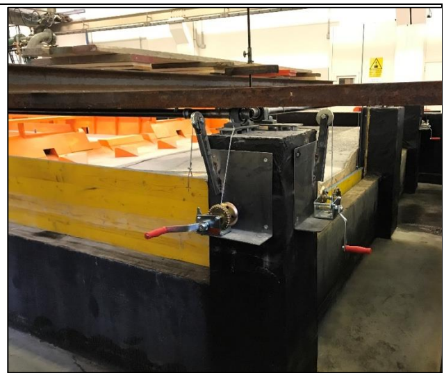
Figura 12 – Sistema di regolazione delle condizione di livello a valle con paratoie a scomparsa del piano di scorrimento a valle della traversa ( sin, vista dall'alto). Particolare degli arganelli di movimentazione delle singole paratoie
