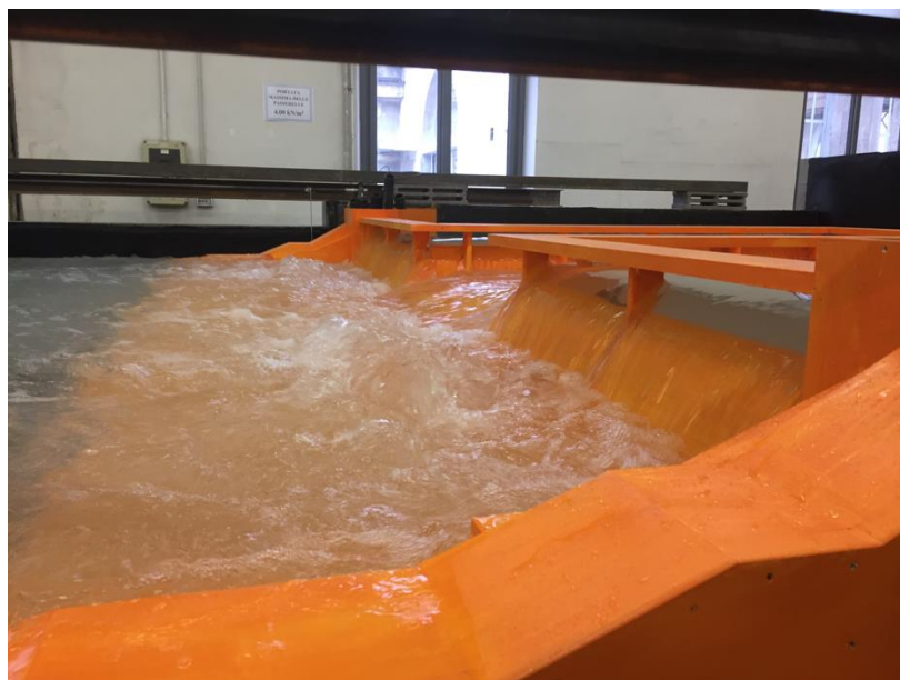
Figura 16 – vene di sfioro sugli sfioratori di superficie nel funzionamento con paratoie chiuse
