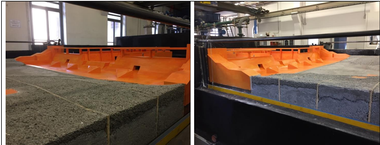
Figura 6 – Il modello fisico completato: particolari degli sfiori e del bacino di dissipazione
