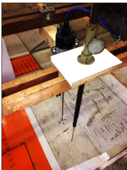
Figura 8 ASTA IDROMETRICA CON NONIO E TRAVE PORTA-ASTA
