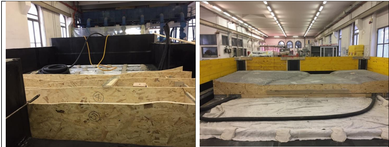
Figura 3 – Fasi di realizzazione del piano di posa della traversa e della sagomatura del fondo dell'alveo a valle della traversa
