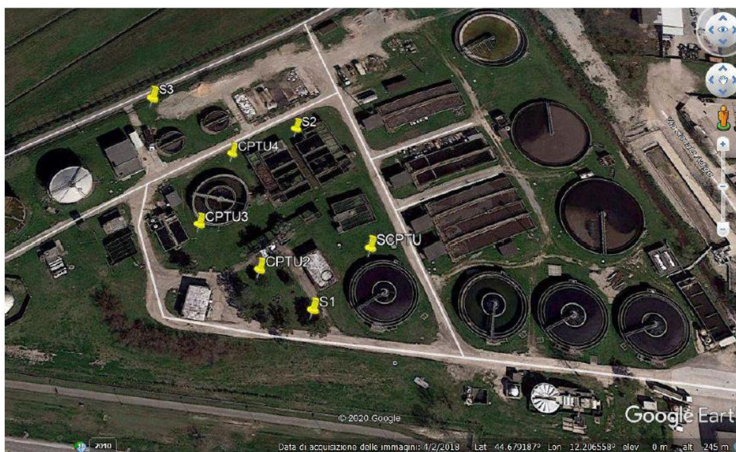
Figura 3.1: Stralcio planimetrico con ubicazione sondaggi e prove penetrometriche
