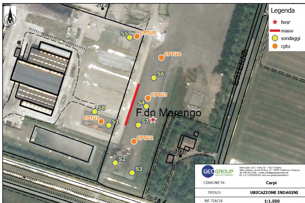
Fig. n. 2.6.1 – Ubicazione delle indagini geognostiche eseguite presso l'area oggetto di produzione delle terre e rocce da scavo.
