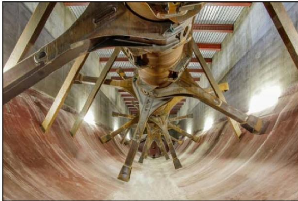
Fig.6.: Particolari degli organi di movimentazione interni del digestore, di tipo longitudinale (in alto) o trasversale (in basso), a seconda del costruttore
