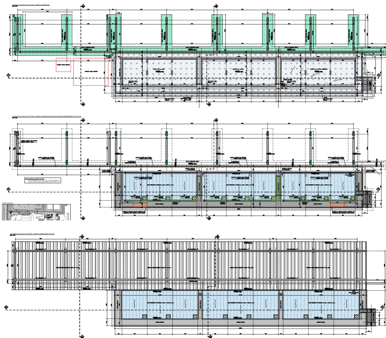
Figura 1.34 – Pianta fondazioni Vasche V4a-b-c e tettoia
